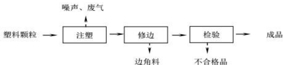
图 3-3 一次性餐饮具工艺流程
