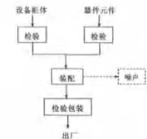
图 3.3.3.3-4 电气设备生产工艺流程图
