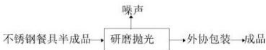
图 3.3.3.2-1 不锈钢餐具生产工艺流程图
