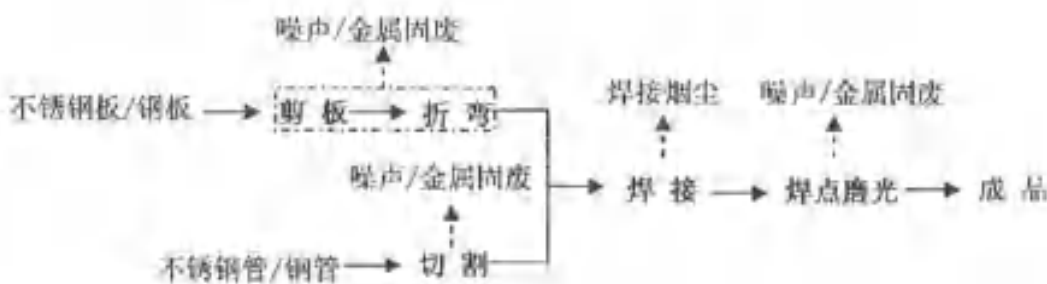
图 3.4.3.11-1 不锈钢厨房设备生产工艺流程
