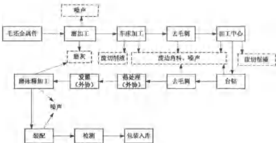
图 3.4.3.3-1 生产工艺流程图
