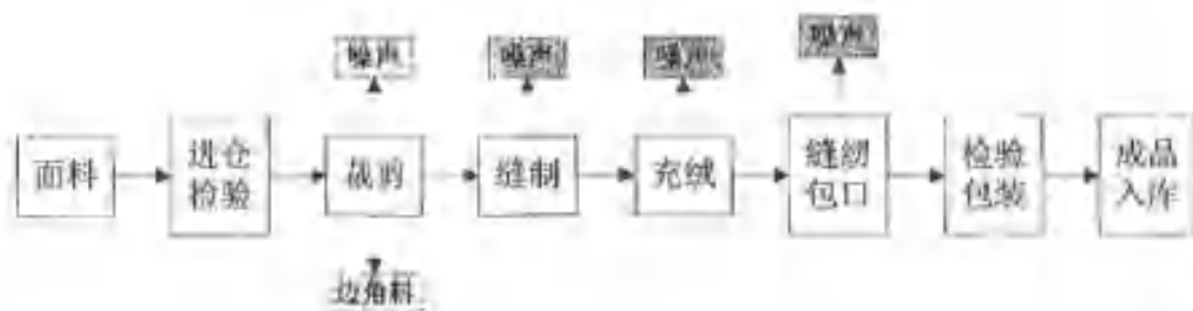
图 3.4.3.8-2 羽绒制品、床上用品、服装（羽绒服）生产工艺流程
