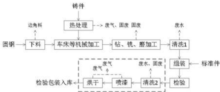
图 2-1 项目农业机械传动总成和机械配件生产工艺流程图及产污环节图
