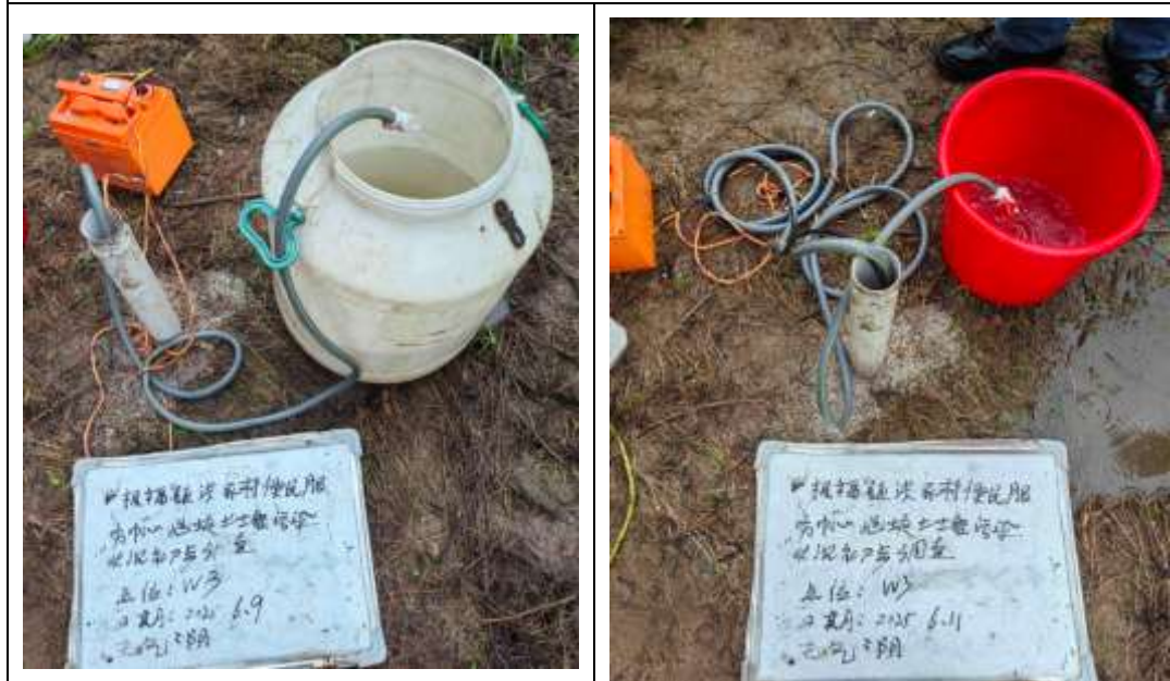
W3 水井洗井照片
