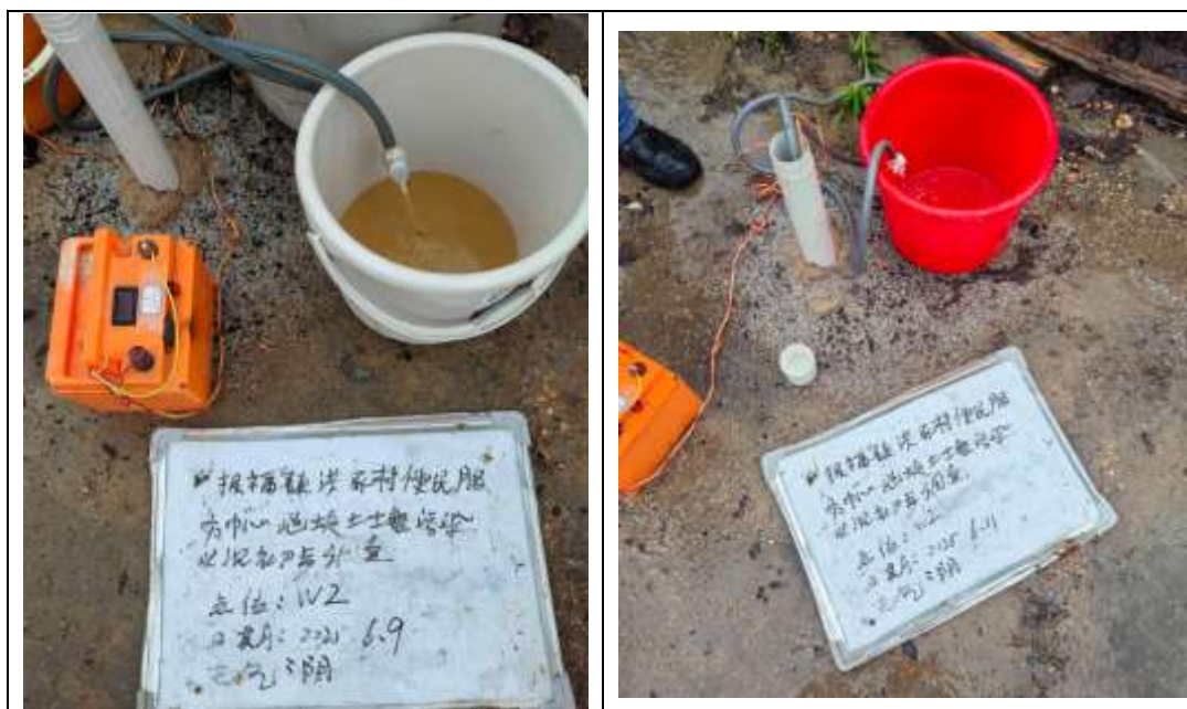
W2 水井洗井照片
