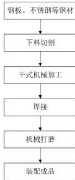
图 3.4-4 茶机烘板、家具配件工艺流程
