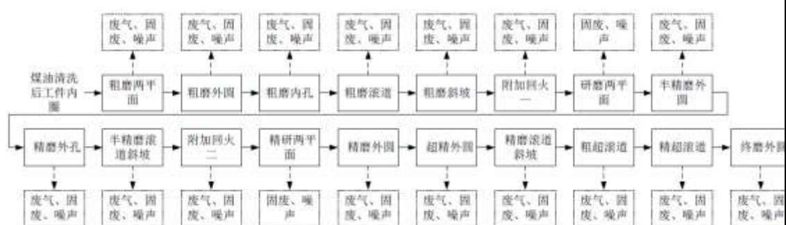
图 2-5 外圈加工工艺流程及产污环节示意图
